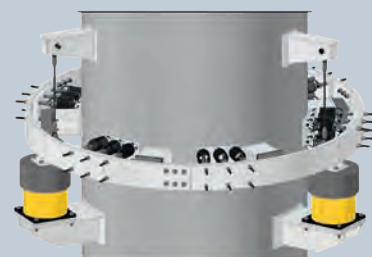
Typische Konstruktion eines Ringtilgers
